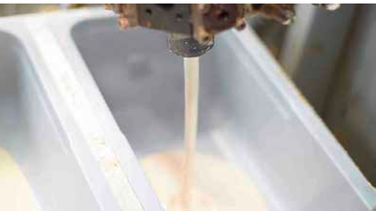
Herstellung der PU-Dämmungen | Production of PU-insulation
