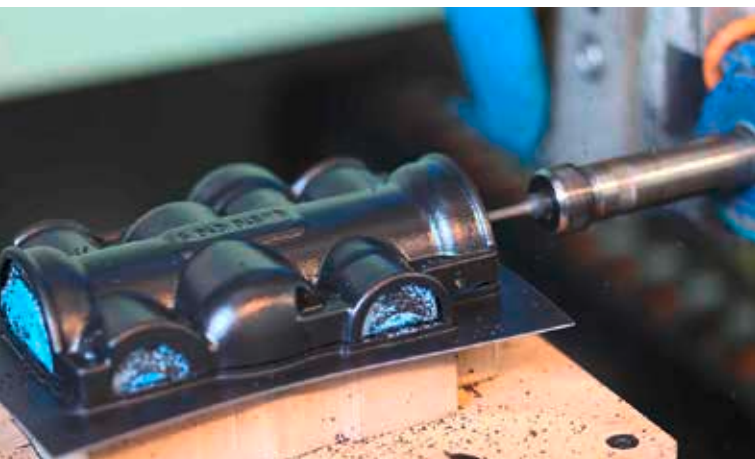
Herstellung der Diffusionsdichten Kälte­dämmungen | Production of diffusion-tight cold insulations
