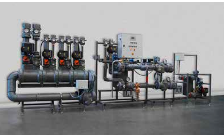
er Übergabestation auf Montagerahmen | Transfer station on mounting frame
