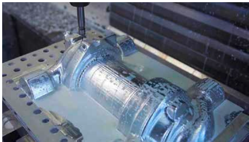
Werkzeuge für unsere Dämmungen fertigen wir selber | We manufacture the tools for our insulation ourselves
