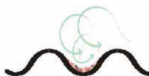
Abbildung 2. Darstellung, wie die turbulente Strömung und die Scherspannungen dabei helfen, den Übertrager sauber zu halten.
