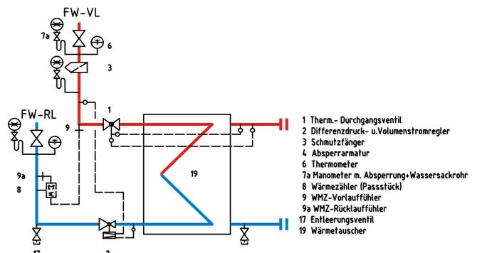
Hydraulik Schema der Station
