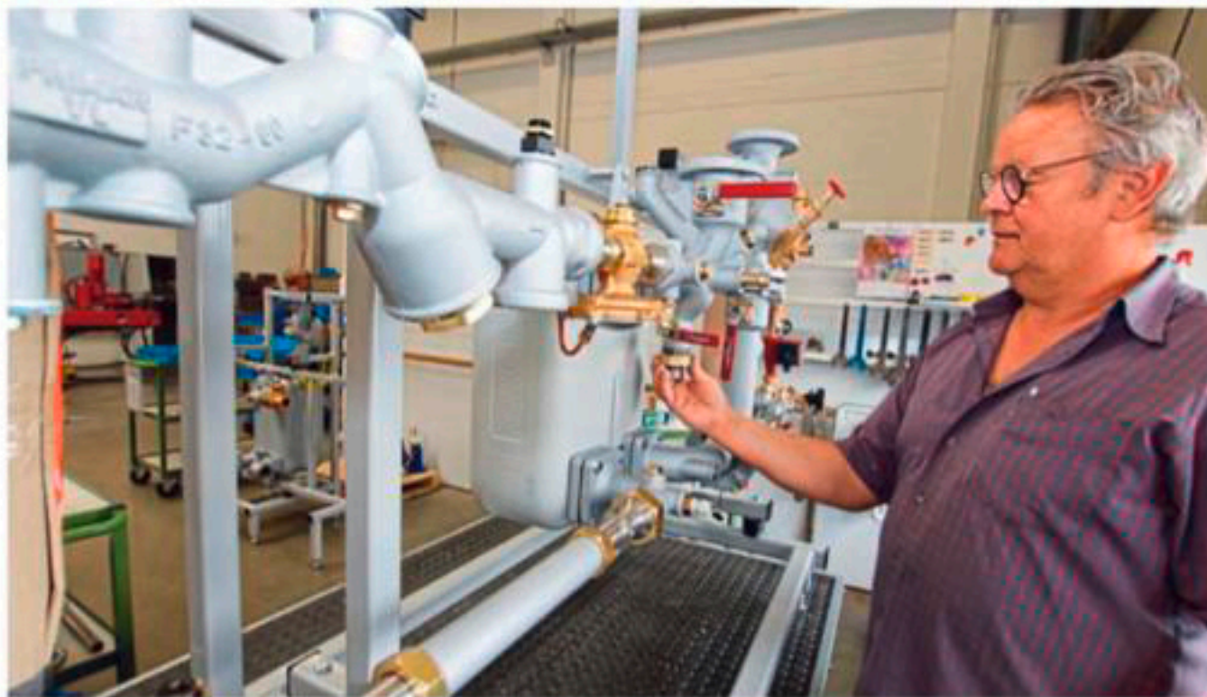
Endmontage: Ingo Brechmann arbeitet seit 40 Jahren bei der Ewers Heizungstechnik GmbH. Er hat die guten Zeiten unter Firmengründer Josef Ewers miterlebt. Als Formteile werden hochwertige Werkstoffe aus Rotguss und Messing eingesetzt, diese Fernwärmeübergabestation geht nach Marl.
