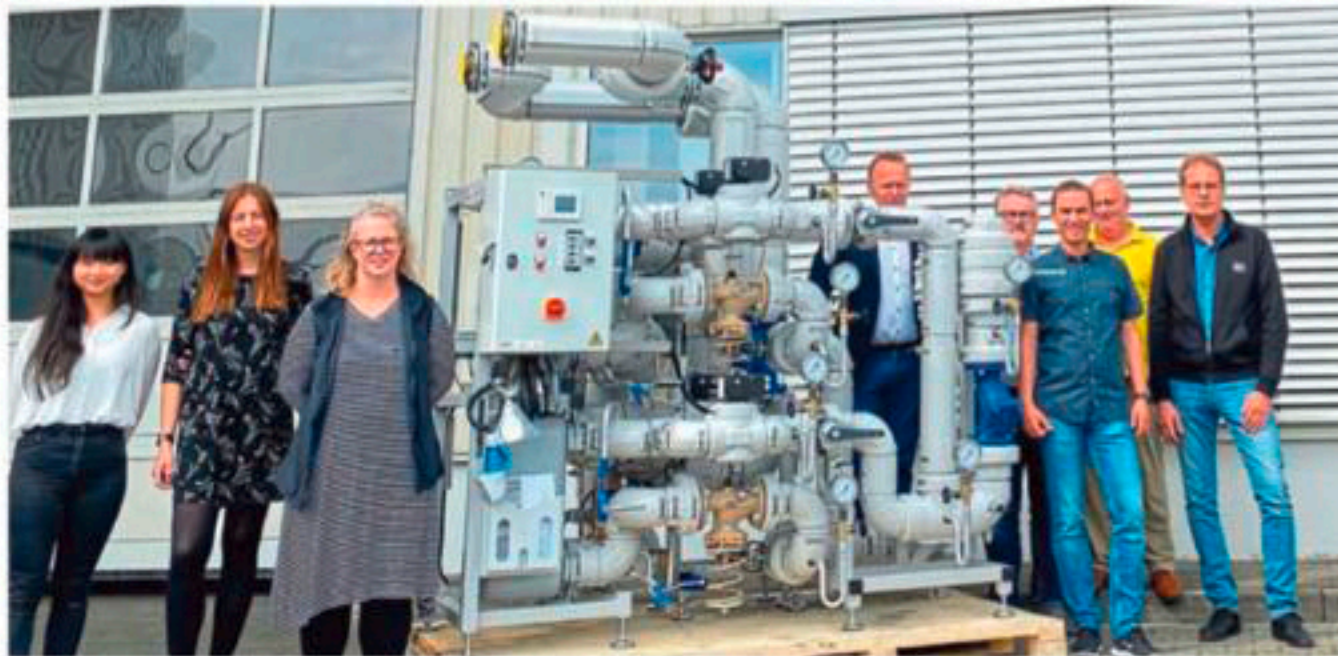
Die Mitarbeiter Ai Zhen He (Auszubildende, v.l.), Viktoria Zeng, Sarah Lippa, Geschäftsführer Thomas Pollmeier, Klaus Eickmeyer, Achim Brasch, Karl Heinz Steudel und Jörg Budde neben einer Station mit einer Leistung von 700 Kilowatt. Sie ist Teil der energetischen Sanierung einer Wohnanlage in Hamburg mit etwa 230 Wohneinheiten.
