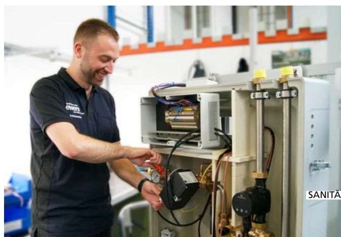
◀ Bild 4 • Abhängig vom verfügbaren Raum und den individuellen Bedürfnissen der Anwender müssen die Wärmeübergabestationen stets individuell ausgelegt werden.
